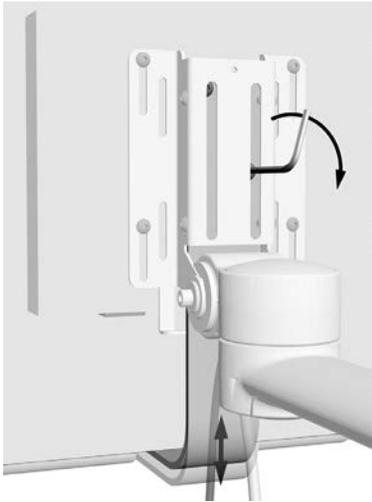
3. Pour positionner la poignée plus près de l'écran, descendre le support sur la poignée. Déplacer la vis du haut en position basse sur la poignée à l'aide d'une clé à six pans 5/32 po.
